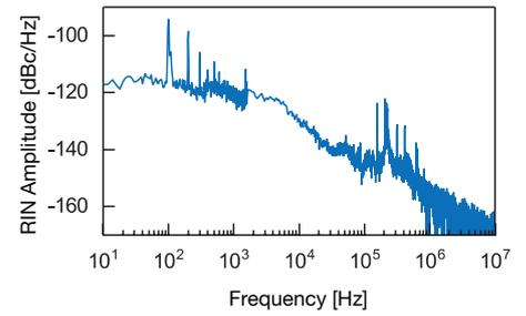
Signal at 1.7  $\mu\text{m}$ : RMS 0.15 %
